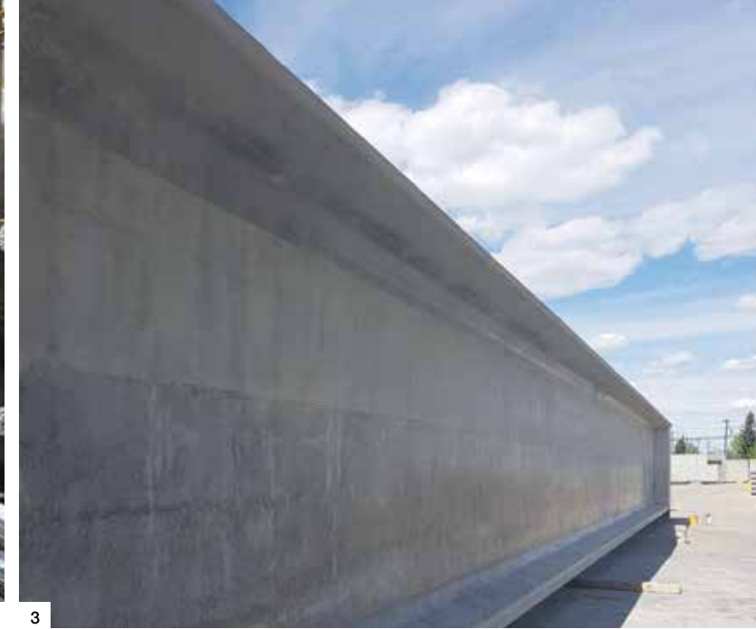
2. and 3. A NU girder under construction in the Lafarge Precast plant in Edmonton showing the placement of rebar and pretensioning strands, and the finished girder./ Fabrication d'une poutre NU dans l'usine de Lafarge Precast à Edmonton démontrant le positionnement de l'acier d'armature, des brins d'acier de pré-tension et la poutre une fois complétée.
