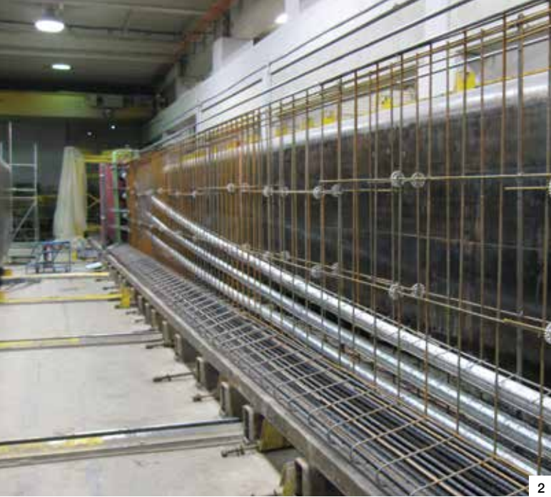
2. and 3. A NU girder under construction in the Lafarge Precast plant in Edmonton showing the placement of rebar and pretensioning strands, and the finished girder./ Fabrication d'une poutre NU dans l'usine de Lafarge Precast à Edmonton démontrant le positionnement de l'acier d'armature, des brins d'acier de pré-tension et la poutre une fois complétée.
