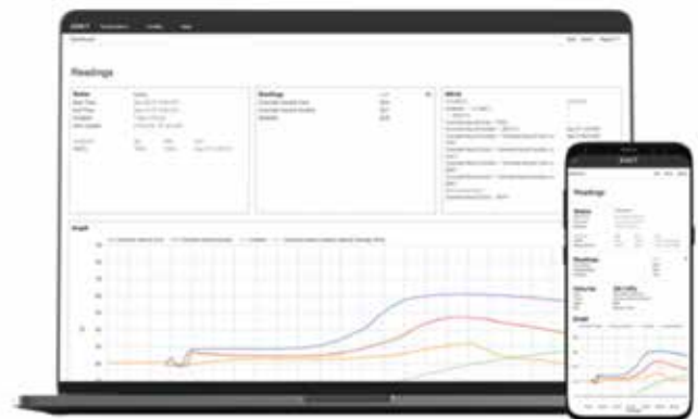
EXACT remote element monitoring via a real-time, online dashboard. Here, the user tracks three locations: element core (temperature), element surface (temperature & maturity), and ambient (temperature). / « EXACT », surveillance d’éléments à distance, sur un tableau de bord en temps réel et en ligne. Ici, l’utilisateur suit trois emplacements : le cœur de l’élément (température), la surface de l’élément (température et maturité) et la température ambiante (température).
