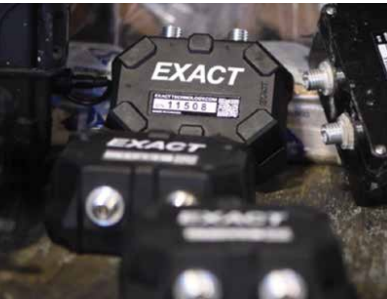
Highly durable EXACT Loggers communicate real-time temperature data, collected from connected probes and an internal ambient temperature sensor, wirelessly to the cloud. / Les enregistreurs « EXACT Loggers » très durables communiquent des données de température en temps réel, collectées à partir de sondes connectées et d’un capteur de température ambiante interne, sans fil vers le nuage.
